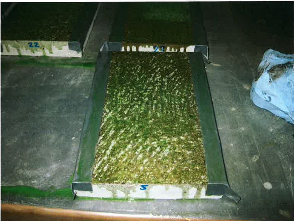
Bild 2 Prüfplatte nach Applikation der Grundierung ELAPERM-CP 01
