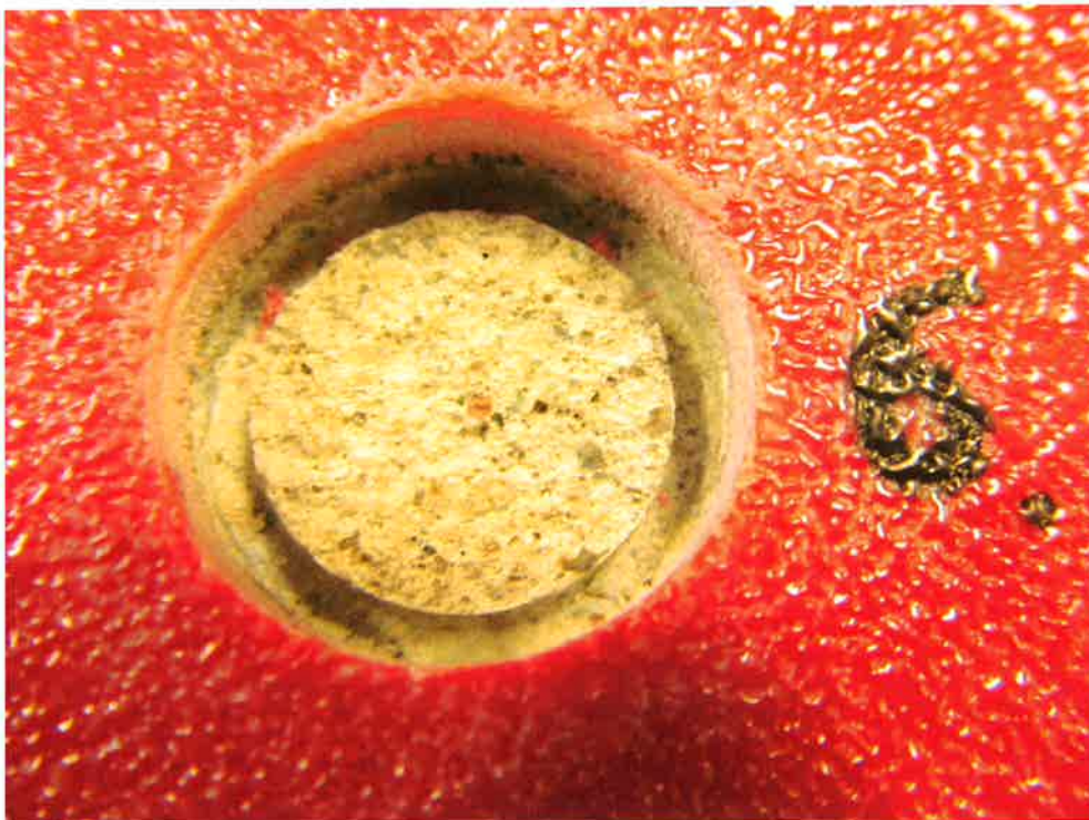
Bild 6 exemplarisches Trennbild der nicht beaufschlagten Beschichtung
