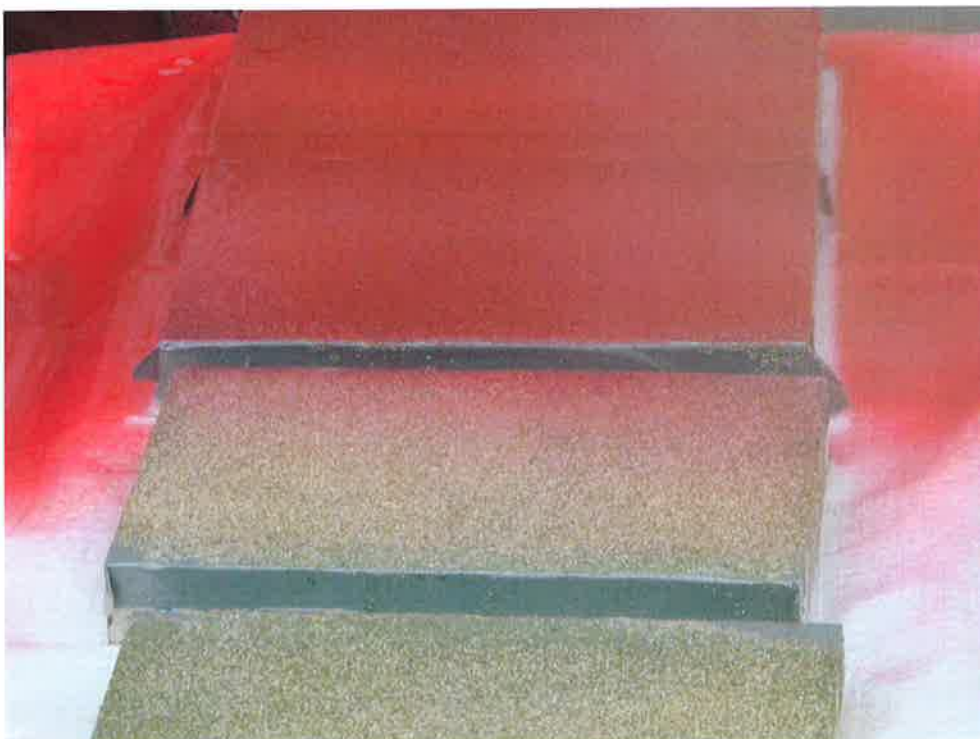
Bild 4 Applikation der Beschichtung ELAPERM-CS 10
