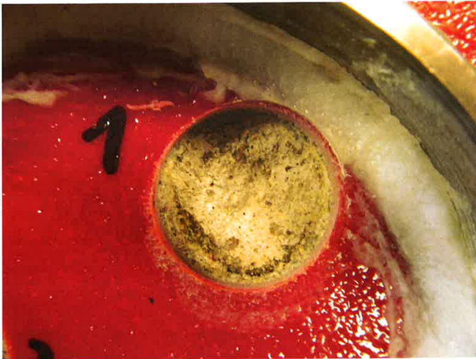
Bild 7 exemplarisches Trennbild nach 3-monatiger Beaufschlag
